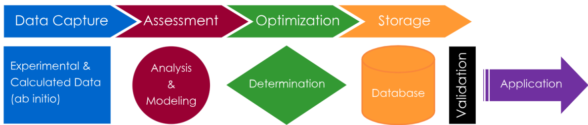
Fig. 6.4 : Méthodologie CALPHAD consistant en quatre étapes principales pour le développement des bases de données matériaux (Thermodynamique, Cinétique et Propriétés) [The23a].
